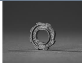
Trivion_08 3D gedruckte Komponente von DokaXact (Doka) aus Metall
